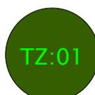
Dies ist die Eingabe der momentanen Zeitzone des Standorts. Durch Drücken der Taste S1 kann der gewünschte Wert eingestellt werden. Wird die Taste mehr als 3 Sekunden nicht betätigt, wird der Wert in der Uhr gespeichert und es erscheint:
