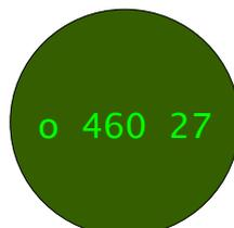
Das linke Zeichen zeigt den Zustand des DCF-Eingangssignals wie die LED an. Die mittlere Zahl zeigt die Dauer des jeweiligen DCF-Pegels an und sollte bei einer DCF-
