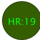
Durch Drücken der Taste S1 kann der gewünschte Wert eingestellt werden. Wird die Taste mehr als 3 Sekunden nicht betätigt, wird der Wert in der Uhr gespeichert und es können die Minuten eingestellt werden:
