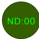
Wird hier „01“ eingegeben, wird die Anzeige der Uhr zwischen der einstellbaren Start- und Ende-Zeit nur kurz alle 10 Sekunden als Analoganzeige eingeblendet, ansonsten bleibt die Anzeige dunkel (**Night Display Mode**). Bei der Eingabe von „00“ wird die Uhrzeit permanent angezeigt. Der eingestellte Wert bleibt auch nach dem Ausschalten erhalten.
