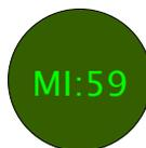
Durch Drücken der Taste S1 kann der gewünschte Wert eingestellt werden. Wird die Taste mehr als 3 Sekunden nicht betätigt, wird der Wert in der Uhr gespeichert und es kann das Jahr eingestellt werden:
